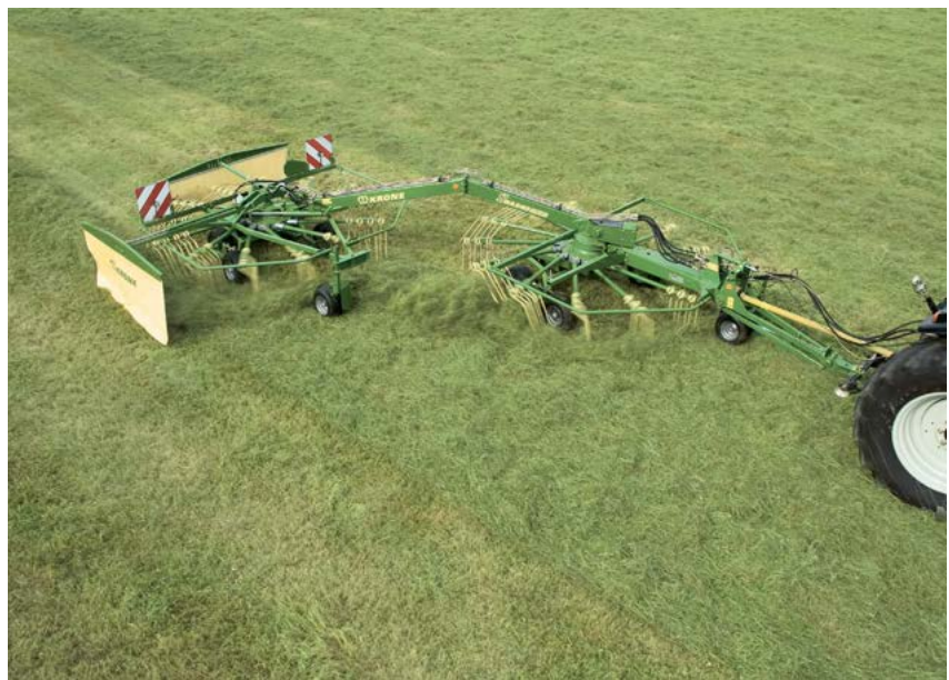
Dépôt de l'andain à droite : commandes du tracteur et andain sont du même côté : un confort de travail certain.
