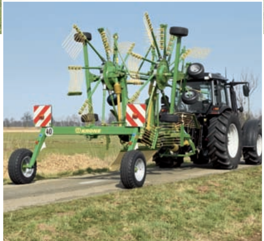
Das Breitspurfahrwerk mit der großvolumigen Bereifung 10.0/75 - 15.3/8 PR ist für eine maximale Höchstgeschwindigkeit von 40 km/h ausgelegt und gibt viel Sicherheit bei schneller Fahrt.
