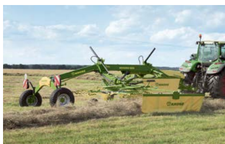
Tažené stranové dvurotorové shrnovače pokosů Swadro TS a TS Twin záběr od 6,20 m do 8,20 m
