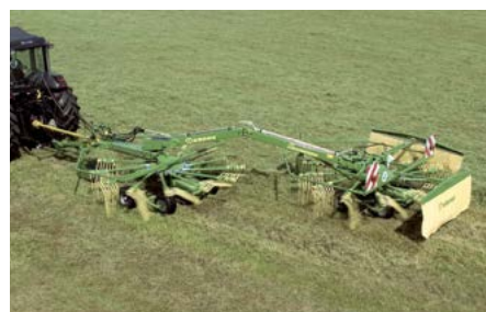
Dvurotorové stranové shrnovače pokosů Swadro 710/26T záběr 6,20 m nebo 2 x 3,40 m
