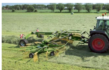
Středové dvurotorové shrnovače pokosů Swadro TC a TC Plus variabilní záběr od 5,70 m do 10,00 m
