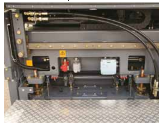
Supporto delle estensioni per variare la larghezza di stesa senza impuntamenti di sorta
