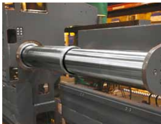
Robuste guide telescopiche monotubo
