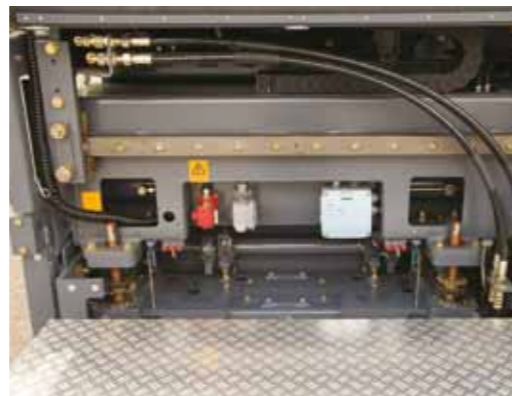
Drehmomentabstützung für klemmfreie Breitenverstellung
