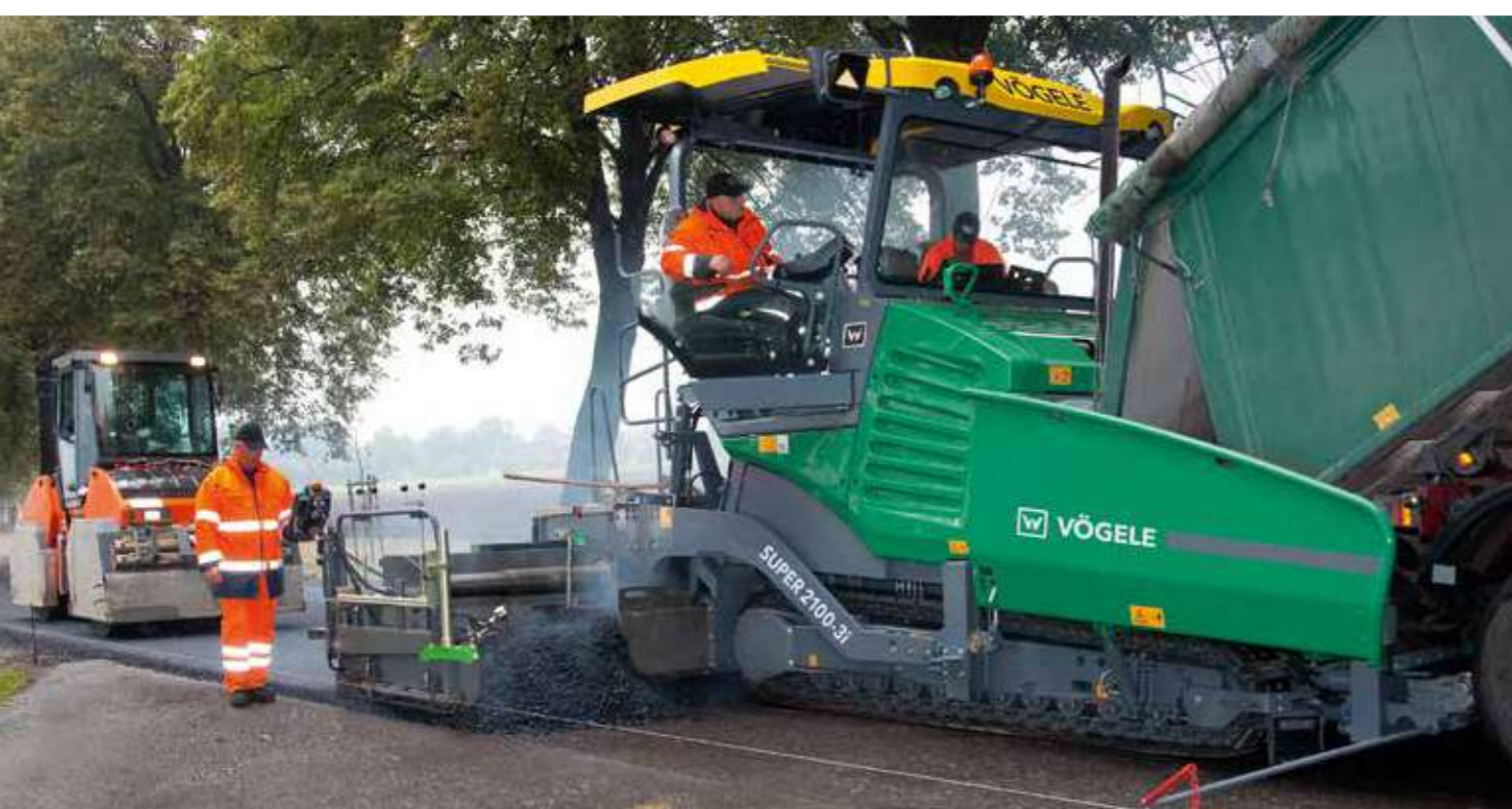
Die Antriebsstation des SUPER 2100-3i erfüllt mit einem Dieselpartikelfilter (DPF), einem Dieseloxydationskatalysator (DOC) und selektiver katalytischer Reduktion (SCR) zur Abgasnachbehandlung die strengen Richtlinien der europäischen Abgasstufe V und der US-Norm EPA Tier 4f.
