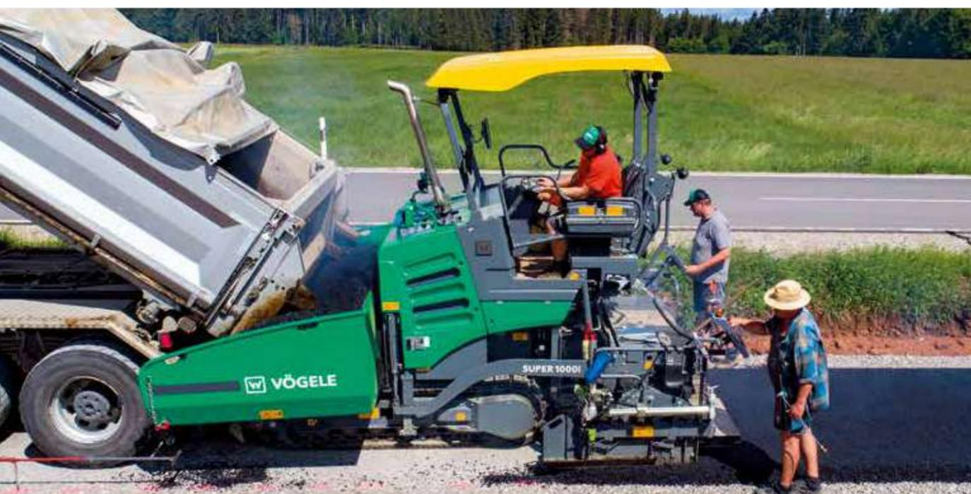
Il propulsore della SUPER 1000i con marmitta catalitica ossidante (DOC) e filtro antiparticolato diesel (FAP) per il post-trattamento dei gas di scarico soddisfa i severi limiti imposti dalle normative antinquinamento Fase V europea ed EPA Tier 4f statunitense.
