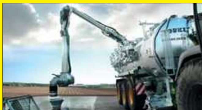
Aspiration sur cône
