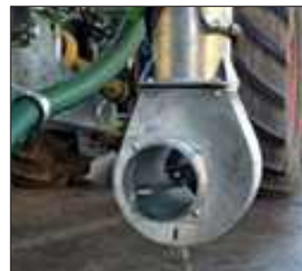
Turbo immergé sur bras articulé
