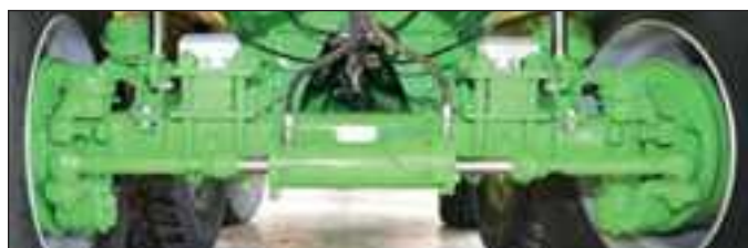
Essieu directionnel forcé (100 % directionnel)
