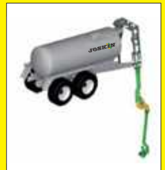
Flèche avant avec turbo immergé
