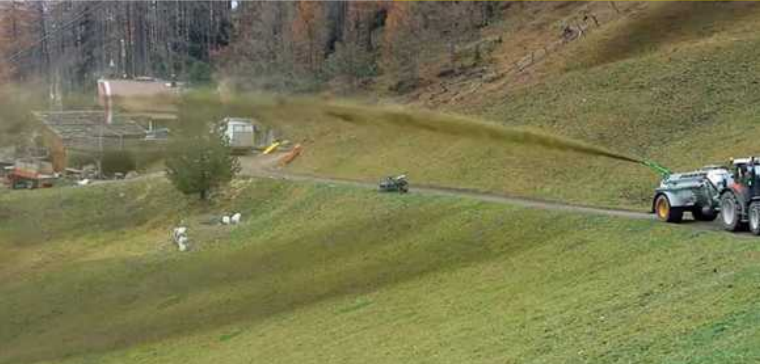
L'épandage par canon évite toute trace de roulage sur la terre cultivée en visant les flancs de collines, accessibles même par-dessus les haies à partir de la route.
