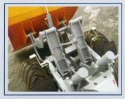
Besonders kraftvoll und produktiv präsentiert sich die Dumper-Serie SMK durch die innovative Kinematik in Verbindung mit den zwei Hubzylindern.
