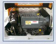
Optimale Wartungsbedingungen und geringe Standzeiten werden durch die gute Zugänglichkeit zum Antrieb und zu den Hydraulikkomponenten garantiert.
