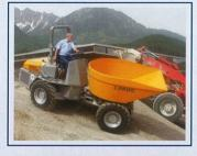
Hohe Betriebssicherheit bei den Dumpern wird durch DSC erreicht, welches verhindert, dass die Dumper bei Talfahrt die zulässige Geschwindigkeit überschreiten.
