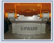
Sehr hohe Langlebigkeit der Dumper wird durch die Hochleistungs-Kugeldrehverbindung, ausgestattet mit zwei doppeltwirkenden Schwenkzylindern, gewährleistet.
