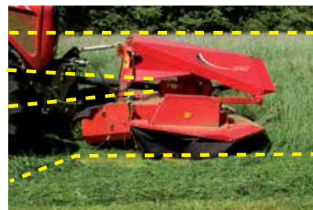
Slåtterbalken vinklas framåt och bakåt så att den förblir parallell i förhållande till marken, när den sänks och höjs i ramen..
