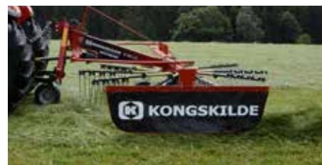
Strängläggare R 365 DS med justerbar strängskärm.
