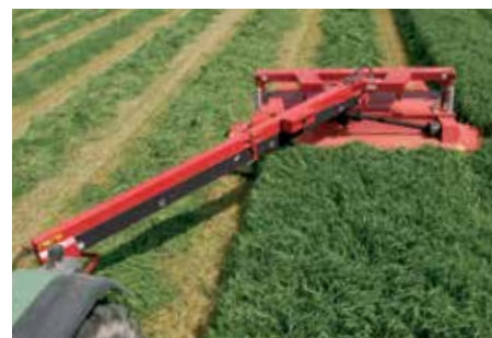
Maszyny Flex są wyposażone w długi, mocny dyszel środkowy.
