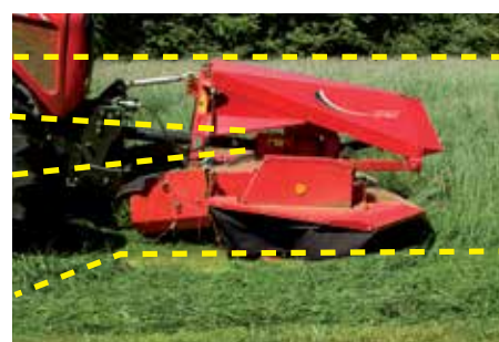
Wychył belki tnącej do przodu i do tyłu w taki sposób, że pozostaje ona w położeniu równoległym względem podłoża.
