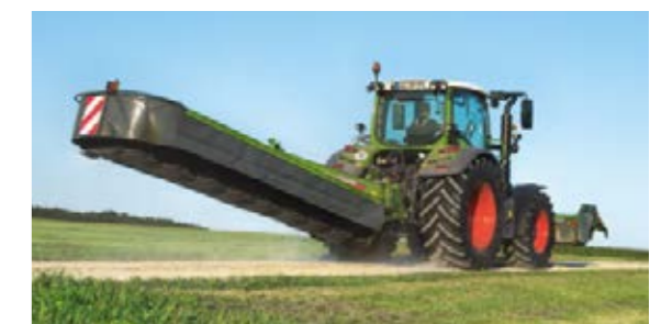
In transportstand wordt de maaier vanuit de cabine 90 graden naar achteren gezwenkt.
