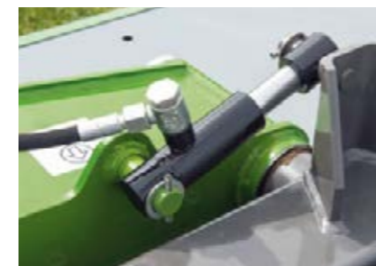
De compensatiecilinder houdt de maaier op de kopakker en bij rijden op de openbare weg veilig op hoogte.
