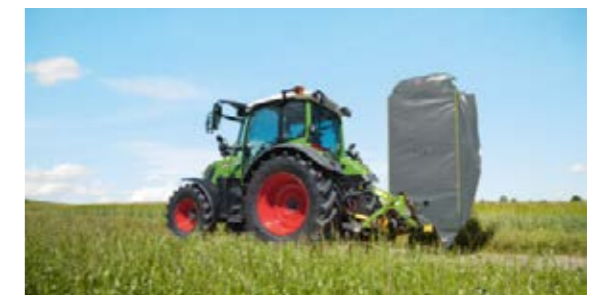
Vanuit de cabine is de machine gemakkelijk van werkstand in de zeer compacte transportstand te zetten, en omgekeerd.
