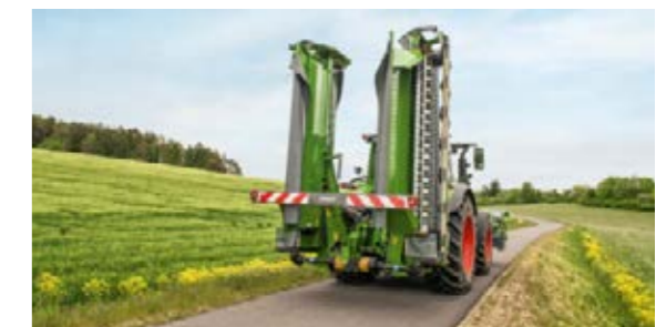
In opgeklapte toestand is de hoogte van de maaiercombinatie nog steeds minder dan 4 meter. Ook zorgt het lage zwaartepunt voor een comfortabel weggedrag.
