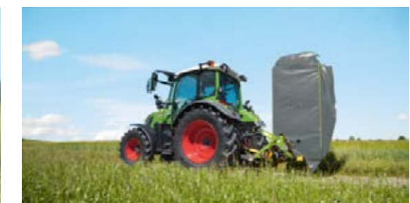
Zmiany pozycji roboczej na kompaktową pozycję transportową można dokonać z komfortowej kabiny ciągnika.
