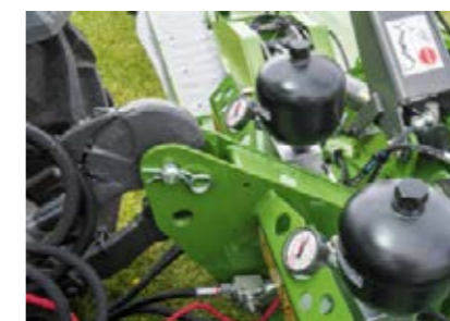
Zawsze monitoruj idealną siłę nacisku systemu TurboLift za pomocą manometru i reguluj ją z wnętrza komfortowej kabiny.
