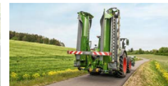
Po złożeniu wysokość kosiarki pozostaje poniżej 4 m, a dzięki niskiemu środkowi ciężkości ciągnik z podłączoną do niego maszyną łatwo się prowadzi.
