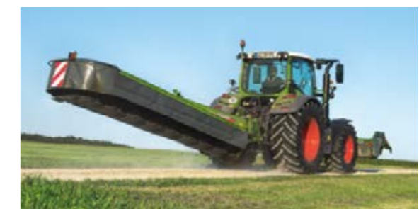
W pozycji transportowej kosiarkę można odchylić o 90° do tyłu bezpośrednio z kabiny.
