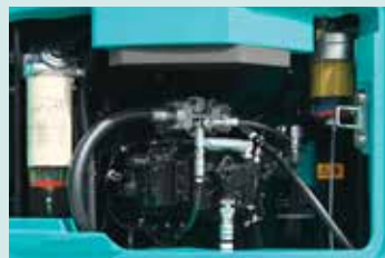
Brandstoffilter met geïntegreerde waterafscheider
