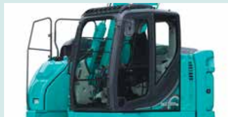
Standaard voorzien van beugels voor vandalismebescherming (neem contact op met uw KOBELCO-dealer voor het plaatsen van vandalisme- of steenslagbescherming).
