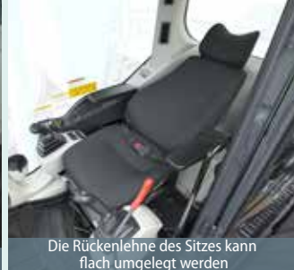
Die Sitzfederung absorbiert Vibrationen
