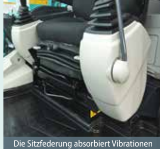
Die Sitzfederung absorbiert Vibrationen
