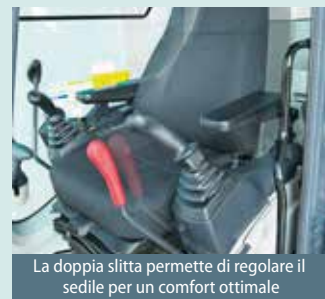
Le sospensioni del sedile assorbono le vibrazioni
