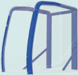
Dach-Schutzgitter Stufe II (erfüllt ISO10262)
