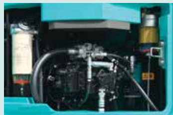
Kraftstofffilter mit eingebautem Wasserabscheider
