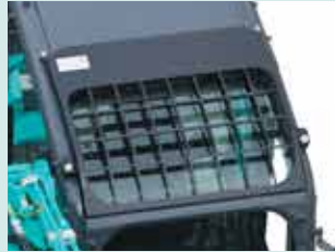
Dach-Schutzgitter Stufe II (erfüllt ISO10262)
