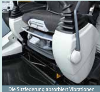
Die Sitzfederung absorbiert Vibrationen
