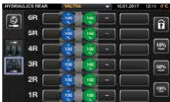
Vous pouvez affecter n'importe quelle commande à n'importe quelle fonction hydraulique, y compris les distributeurs hydrauliques avant et arrière, le relevage avant et arrière et le chargeur frontal.
