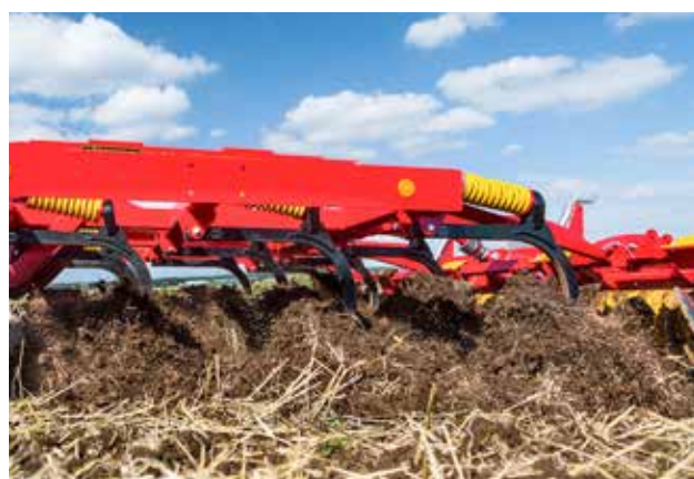
Высокопроизводительной стойки Cultus работает на глубине до 25 см.
