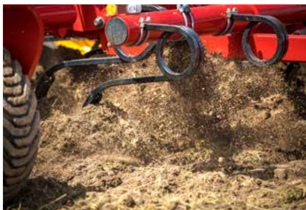
Вибрирующие стойки Swift обеспечивают интенсивное перемешивание на глубине до 20 см.
