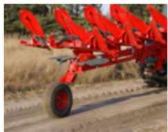
KOŁO PODPOROWO- TRANSPORTOWE TYLNE Pozwala na dokładne ustawienie głębokości roboczej, rozłożenie masy pługa, a także usprawnia poruszanie się po drogach publicznych odciążając układ hydrauliczny ciągnika.
