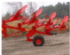
KOŁO PODPOROWO- TRANSPORTOWE BOCZNE Pozwala odciążać podnośnik ciągnika podczas transportu pługa oraz usprawnia poruszanie się po drogach publicznych.
