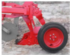
KOŁO PODPOROWE TYLNE Pozwala na dokładne ustawienie głębokości roboczej oraz utrzymanie jej na zadanym poziomie. Zapewnia lepsze rozłożenie ciężaru pługa.
