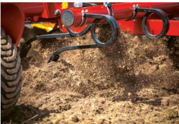
De triltanden van de Swift zorgen voor een intensieve menging tot op 20 cm diepte.
