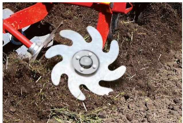
Om op verschillende bodemomstandigheden te kunnen inspelen, kan de bestuurder onder het rijden de intensiteit van de hydraulische egalisatieschijven tot op de millimeter nauwkeurig instellen.
