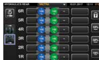
Możliwość sterowania elementami układu hydraulicznego, w tym zaworami hydraulicznymi (przednimi i tylnymi), podnośnikami (przednim i tylnym) oraz ładowaczem czołowym.
