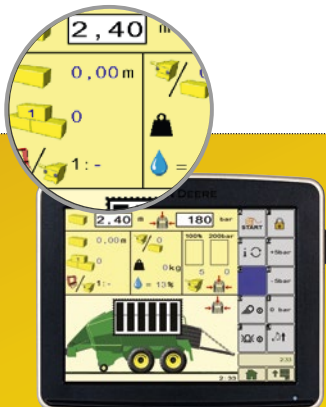
Das Gewicht der Ballen wird am Display angezeigt (Option).
