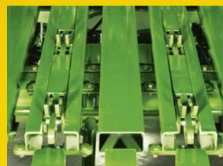
Der zuletzt gepresste Ballen wird mittels hydraulischer Gabel sauber ausgeworfen.
