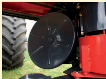
De machine is standaard voorzien van twee zwadschijven, die een zwadbreedte van 2,2 - 2,4 m mogelijk maken.
