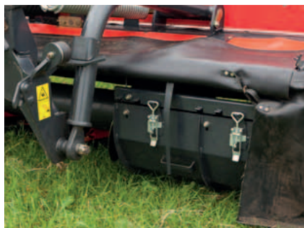
De zwadbreedte is eenvoudig verstelbaar door de geleidingsplaten te de-blokkeren en te verschuiven naar de gewenste positie.
