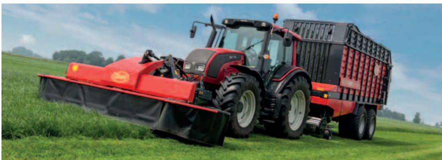
EXTRA 332XF FlexiSwat past perfect bij een opraapwagen voor stalvoeren.
