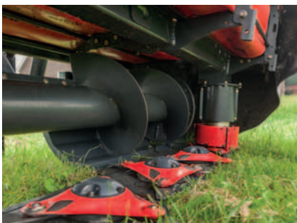
Het actief aangedreven zwadvormsysteem legt het gras op gelijkmatige en 'vierkante' zwaden.
