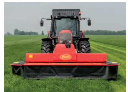
De Eco-aandrijving is standaard op de EXTRA 332XF FlexiSwat. Door het omdraaien van de poelies is het ook mogelijk om met slechts 750tpm op de frontaftakas te maaien, waardoor brandstof bespaard kan worden.
