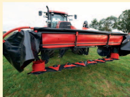
Gemakkelijk toegankelijke maaibalk met opklapbare front- en zijplaten.
