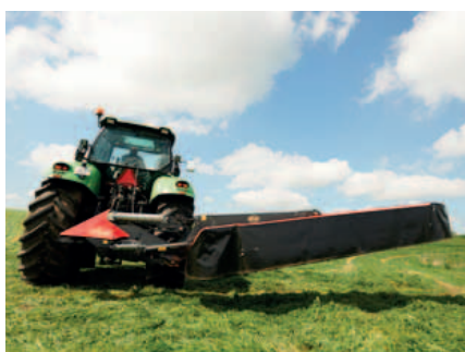
Uitheffen op de kopakker m.b.v. hydraulische cilinder - ruime bodemvrijheid.
