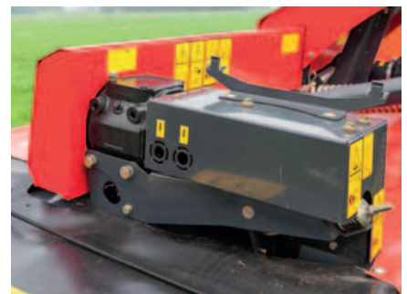
De FlexiSwat vijzel wordt aangedreven via een compacte tandwielkast met een extra benodigd vermogen van slechts 5pk.
