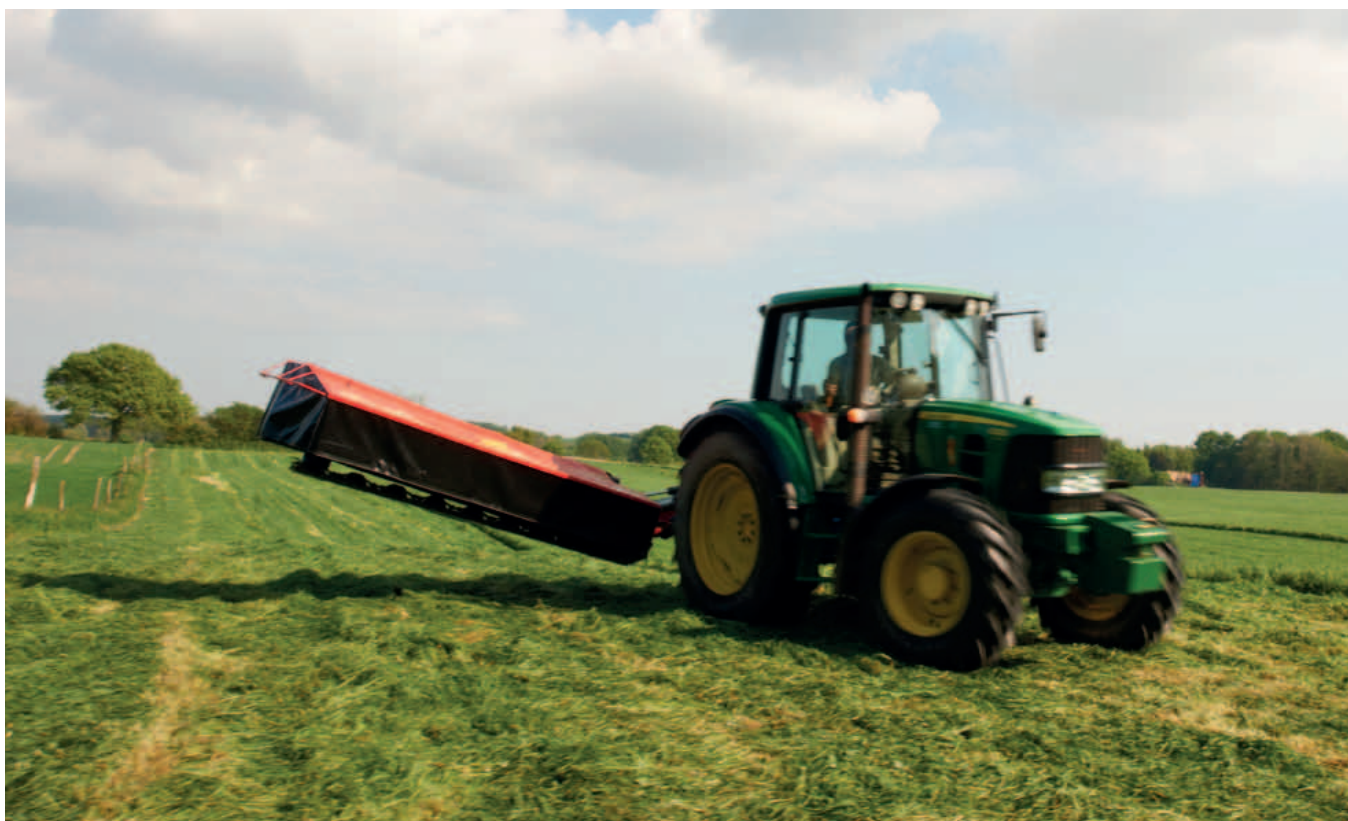
Uitheffen op de kopakker m.b.v. hydraulische cilinder.
