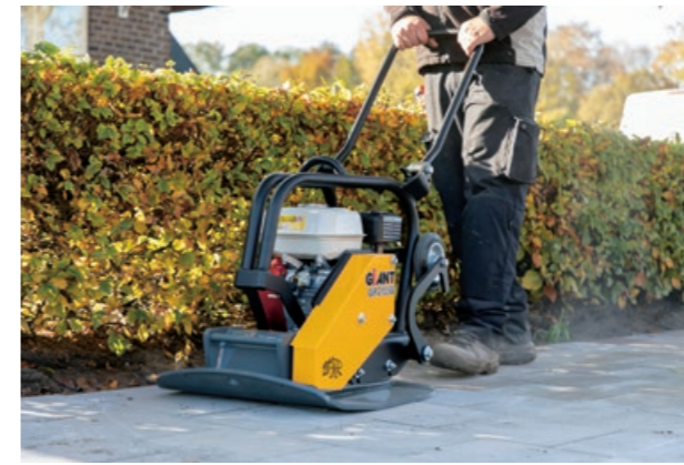
Der GP2155G im Einsatz auf der Baustelle - ideal für die Befestigung von Platten und Pflastersteinen
