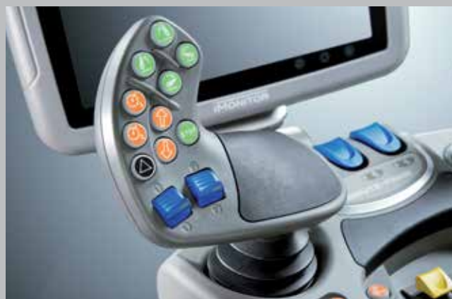
Modele TTV. Podłokietnik z joystickiem, skrzynia bezstopniowa i maksymalny komfort użytkownika.
