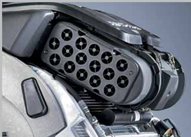
Układ wstępnego oczyszczania powietrza na obudowie filtra PowerCore: spiralne kanaliki i przewód przechwytyją 95% cząstek pyłów, zanim powietrze dostanie się do głównego filtra.
