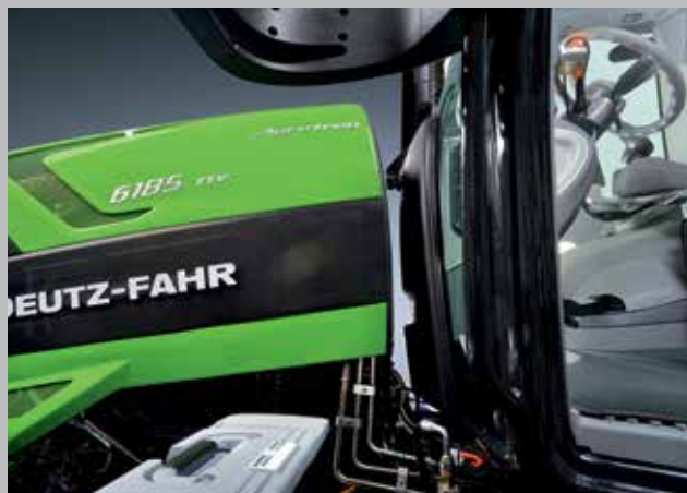
Kabina jest oddzielona od komory silnika, co znacznie obniża poziom hałasu i drgań, a tym samym pozwala zapewnić maksymalny komfort.
