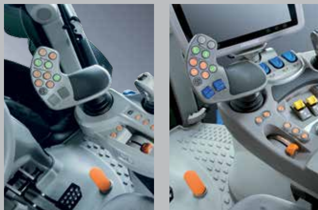
Modele RCshift. Zrobotyzowana przekładnia Powershift, podłokietnik z joystickiem, brak dźwigni zmiany biegów.
