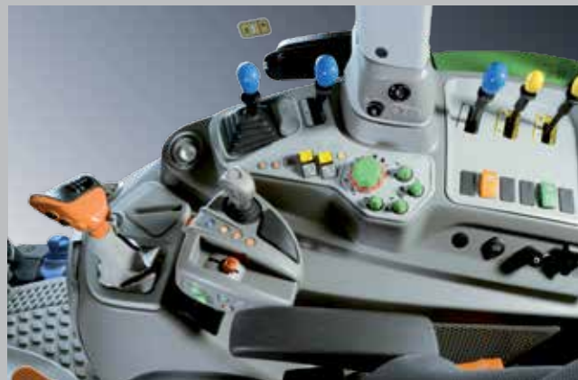
Modele Powershift. Manualna zmiana biegów i półbiegów, klasyczna dźwignia zmiany biegów na prawej konsoli.
