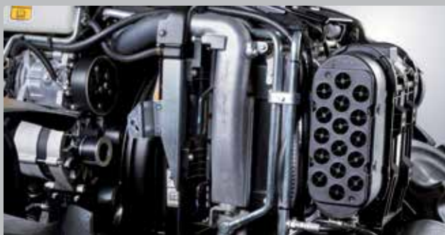
... oraz wydajny pakiet chłodnic z wentylatorem ze sprzęgłem wiskotycznym.
