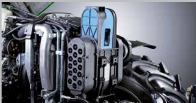
Filtr powietrza PowerCore w technologii nano-włókien ...
