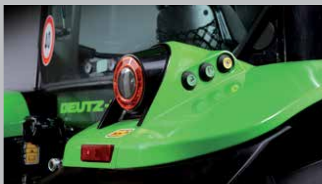
Przyciski sterowania WOM i podnośnikiem na błotnikach kabiny.
