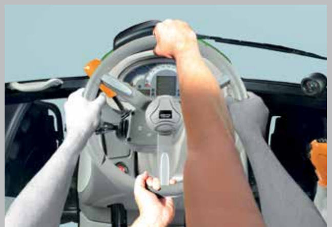
Układ kierowniczy SDD z redukcją liczby obrotów kołem kierownicy. Dwa razy szybsze manewrowanie.
