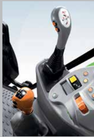
Joystick z przyciskami do zmiany półbiegów Powershift, przyciski funkcji Stop&Go, układu kierowniczego SDD ...
