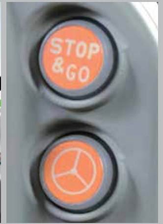
Joystick z przyciskami do zmiany półbiegów Powershift, przyciski funkcji Stop&Go, układu kierowniczego SDD ...
