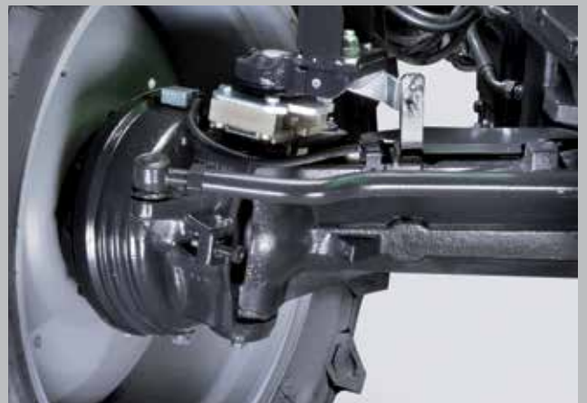
Bezpieczeństwo według DEUTZ-FAHR. Tarcze hamulcowe w kąpeli olejowej na czterech kołach ciągnika.
