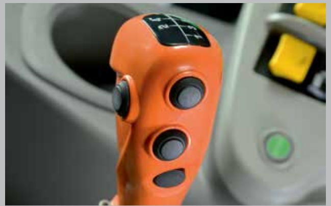
Przycisk sprzęgła ComfortClutch i przyciski zmiany półbiegów Powershift pod obciążeniem umieszczono na dźwigni zmiany biegów.
