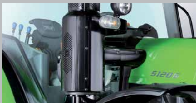
Układ oczyszczania spalin SCR z płynem AdBlue.
