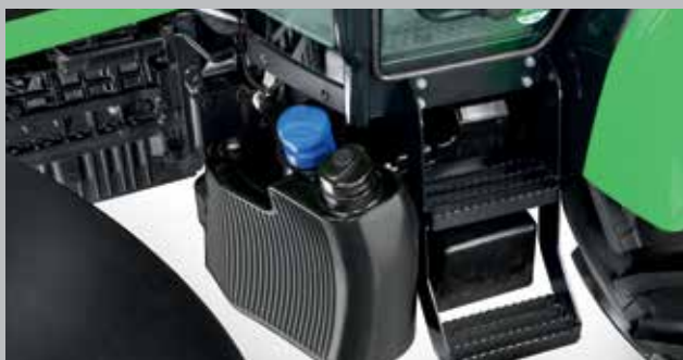
Zbiornik paliwa o pojemności 145 litrów i zbiornik AdBlue o pojemności 10 litrów (zależnie od modelu) z korkami wlewów przy wejściu do kabiny.
