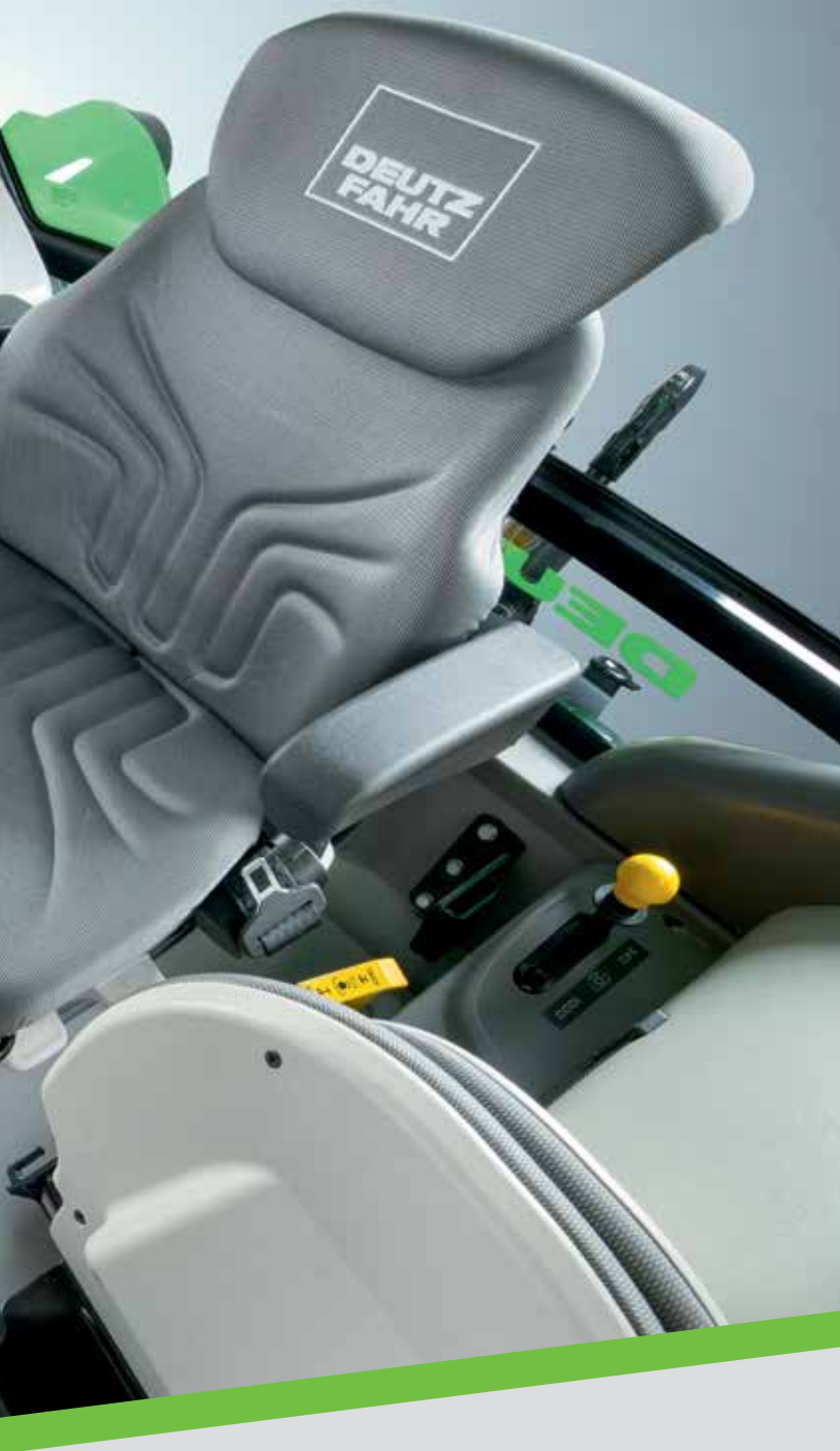
Nowe hydrauliczne Silent-Blocki redukują 40% więcej wibracji niż ich poprzednia generacja z mechanicznymi Silent-Blockami.
