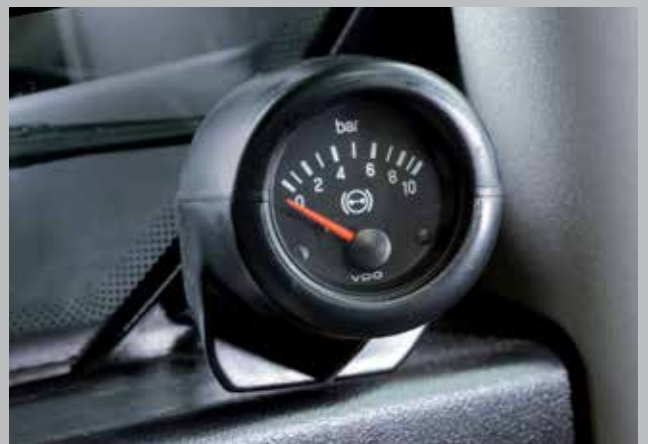
Wskaźnik ciśnienia w pneumatycznym układzie hamulcowym przyczep.
