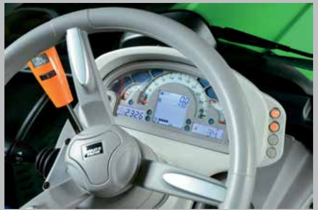
Zegary z wyświetlaczem InfoCenter. Wskaźniki analogowo-cyfrowe z pełną informacją na temat parametrów roboczych ciągnika.
