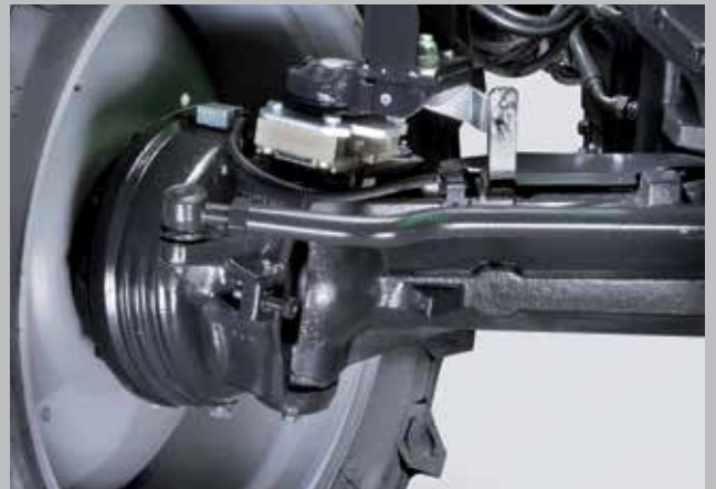
Een uniek veiligheidsconcept van DEUTZ-FAHR. Aparte oliegekoelde remschijven op de vooras.
