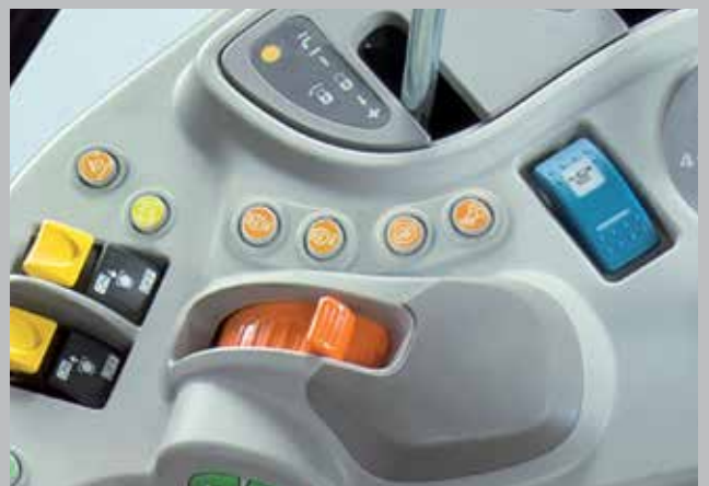
Nieuw: twee motortoerentalinstellingen. Voorgeprogrammeerde efficiëntie voor routinematige handelingen.
