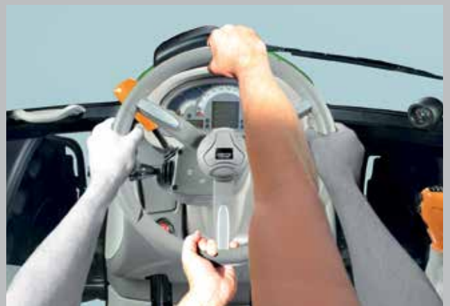
Het SDD-snelstuursysteem. Dubbel zo veel stuurvermogen, maar de helft minder stuurromwentelingen
