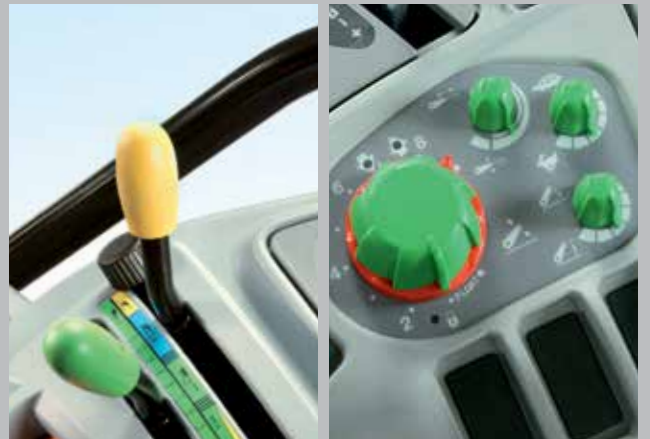
Mechanische of elektronisch bediende hefinrichting achter. De keuze is aan u.
