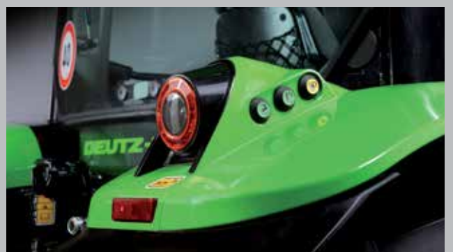
Externe bediening van aftakas en hefinrichting voor praktisch aankoppelen van werktuigen en van buitenaf manoeuvreren met werktuigen.
