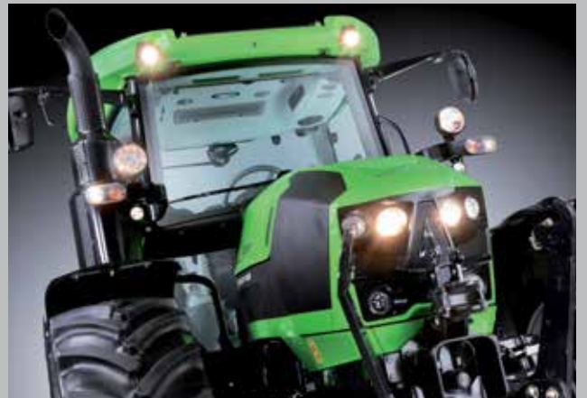
Voor optimaal zicht tijdens slechte weersomstandigheden. Acht werklampen aan het dak en de breedtelichthouders. Twee koplampen in de motorkap.
