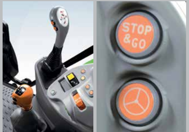
Voorladerjoystick met Powershift-knoppen, Stop&Go, SDD-snelstuursysteem ...
