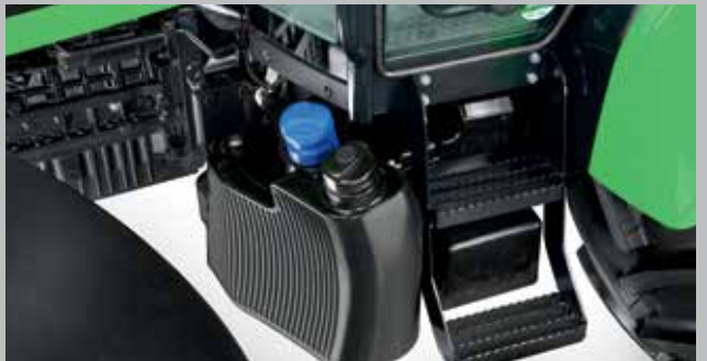
De brandstoftank met een inhoud van maar liefst 145 liter en 10 liter AdBlue zorgen voor lange inzetbaarheid.
