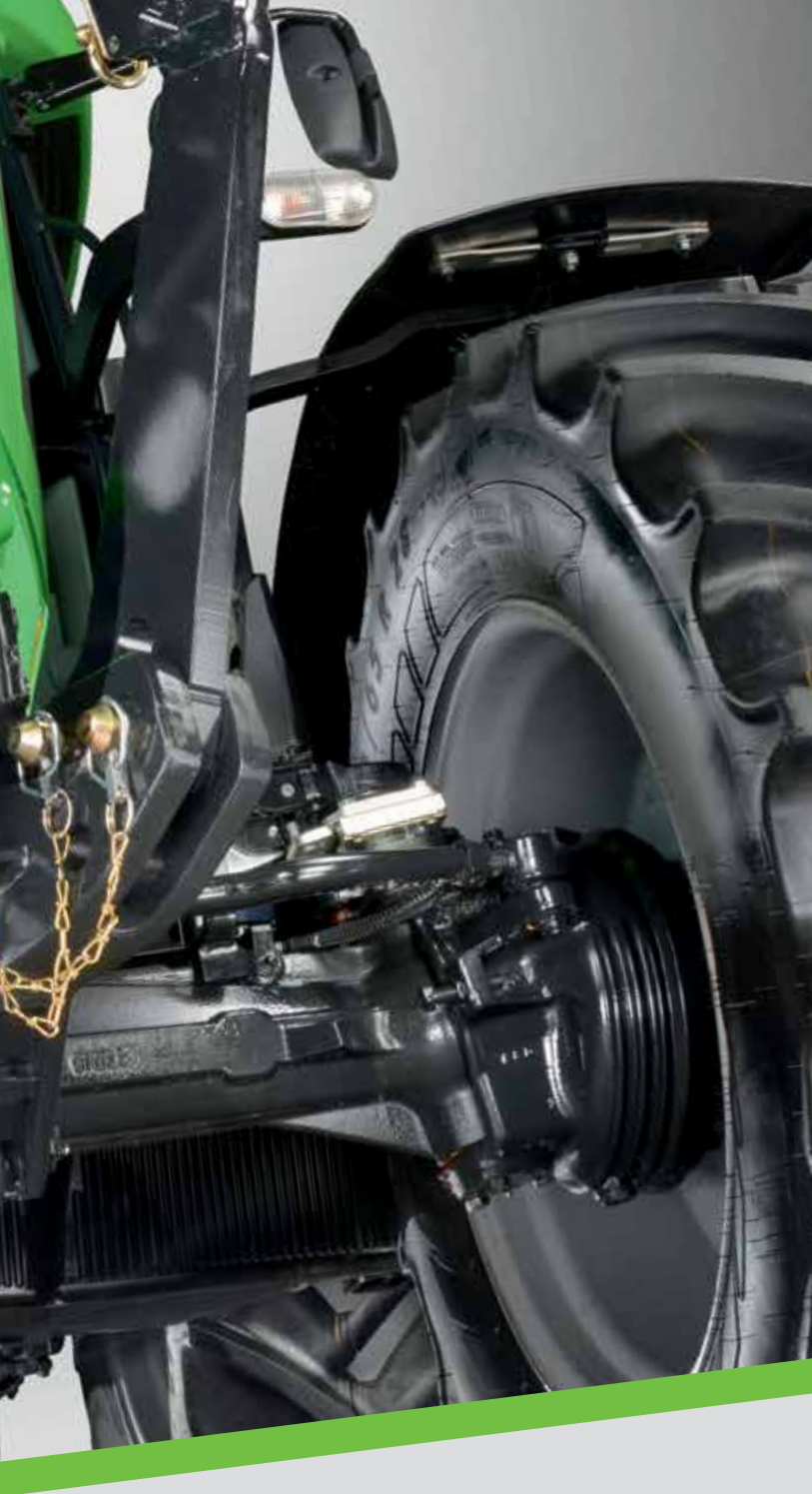
Een uniek veiligheidsconcept van DEUTZ-FAHR. Aparte oliegekoelde remschijven op de vooras.
