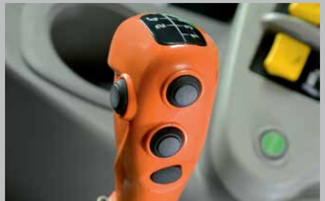
ComfortClutch en Powershift. Schakelen wordt simpel met een druk op de knop, zonder de koppeling te gebruiken.
