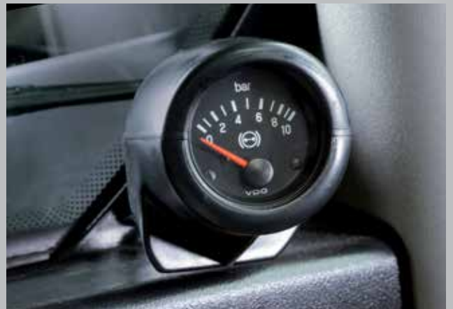
Luchtremstelsysteem (optioneel) voor veilig remmen van zware aanhangers.
