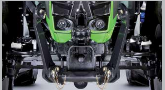
Fronthefinrichting en frontaftakas. Hefvermogen van 2100 kg en frontaftakas met 1000 omw/min.
