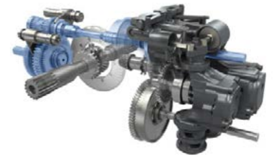
Подача мощности непосредственно на VOM гарантирует превосходную эффективность. Снижение частоты вращения выполняется непосредственно на VOM.
