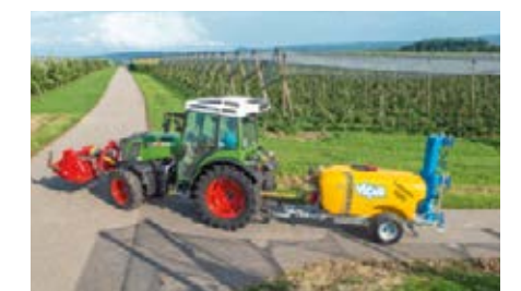
Эффективная комбинация процессов. Благодаря переднему VOM 540E/750 можно использовать измельчитель с требуемой частотой вращения несмотря на то, что в задней части трактора установлен опрыскиватель и двигатель работает на пониженных оборотах.
