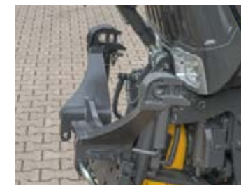
Нижние тяги переднего гидравлического оборудования можно сложить за несколько действий, чтобы обеспечить компактность размеров.
