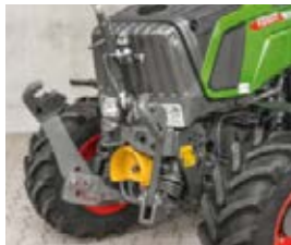
Передний механизм навески в комплектации P имеет грузоподъемность 2540 даН.
