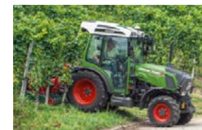
Работа VOM не зависит от скорости движения трактора. Например, можно двигаться с небольшой скоростью при измельчении густой нескошенной культуры, а затем плавно увеличить скорость без переключения передач, если культура станет более редкой.
