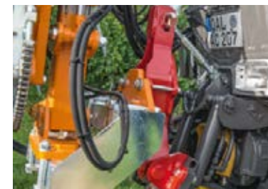
Монтажные пластины, встроенные в передний механизм навески, обеспечивают надежную и прочную опору для тяжелого передненавесного оборудования.
