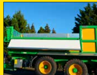
Côté rabattable commandé hydrauliquement
