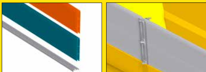
Système d'emboîtement des rehausSES alu
