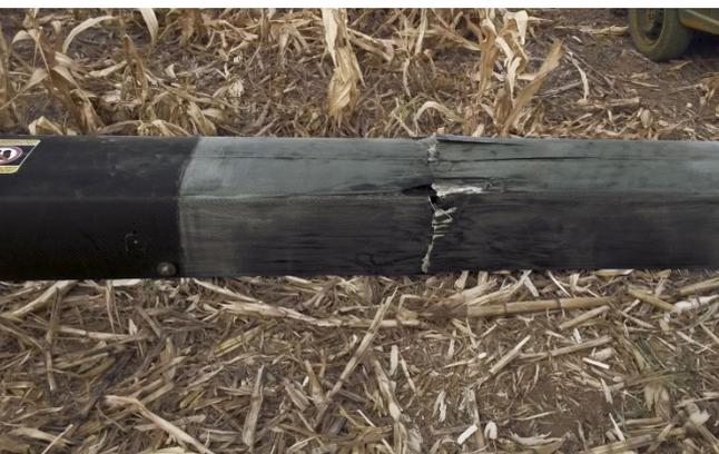
Las secciones de la barra de pulverización de fibra de carbono puede repararse aunque se hayan cortado totalmente. Es posible hacer fácilmente reparaciones que normalmente requerirían la sustitución completa de una barra de pulverización de acero o de aluminio.
