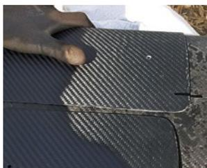
Las nuevas secciones de fibra de carbono, proporcionadas en el conjunto de reparación, pueden cortarse para su adaptación al perfil de la sección dañada de la barra.
