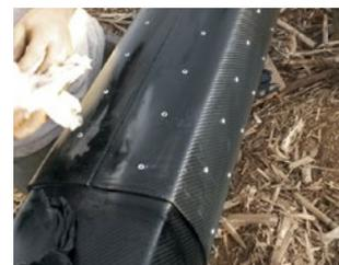
Una vez adherida y remachada la nueva sección de fibra de carbono, la barra de pulverización reparada es tan resistente como la original.
