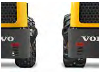
Ромбовидный протектор и шина с повышенными сцепными свойствами
