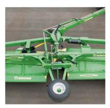
Nach links – nach rechts: Die mittig angelenkte Deichsel ist hydraulisch schwenkbar. Der doppeltwirkende Hydraulikzylinder arbeitet auch unter schwierigen Bedingungen zuverlässig.
