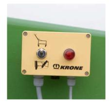
Schwadklappen nach links, Schwadklappen nach rechts – das Ein- und Ausschwenken der Deichsel für die Arbeits- und Transportstellung: Das geht einfach. Die Vorwahl der einzelnen Funktionen erfolgt über die elektrische Bedienbox.
