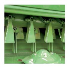
Alles aufs Band: Beim Einsatz des Querförderbandes müssen die V-förmigen Stahlzinken nicht nur aufbereiten, sondern auch fördern. Zur Erhöhung der Wurfleistung ist ein Teil der Zinken geschlossen
