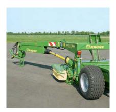
Drehzahlstabil: Der kraftschlüssige Direktantrieb über Wellen und Getriebe bietet Vorteile im schweren Futterbestand und bei großer Arbeitsbreite. Die Hauptgetriebe aller gezogenen EasyCut sind serienmäßig für die Zapfwellendrehzahl von 1.000 U/min ausgerüstet.
