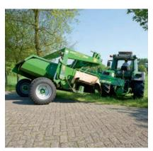
Viel Bodenfreiheit: Für den Transport, aber auch zum Überfahren bereits gemähter Schwaden lässt sich der Doppelrahmen mit der Mäheinheit über einfachwirkende Hydraulikzylinder ausheben. Für den Straßentransport werden die Zylinder über einen Absperrhahn geschlossen.
