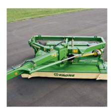
Von links nach rechts, von rechts nach links: Das geht komfortabel und einfach vom Traktorsitz aus. Für die Arbeit wird der Mäher über den doppeltwirkenden Hydraulikzylinder zur linken oder rechten Seite und für den Transport zur Mitte hin geschwenkt.
