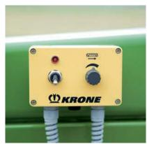
Komfort mit Bedienbox: Leicht lässt sich die Geschwindigkeit des Querförderbandes über ein Drehpotentiometer vom Traktorsitz aus ändern. Mit dieser Einstellung bestimmen Sie die Wurfweite und die Ablage des Mähgutes auf oder neben dem bereits liegenden Schwad.
