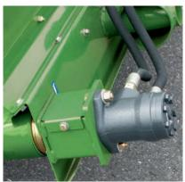
Starker Ölmotor mit stufenlos einstellbarer Bandgeschwindigkeit: Damit stimmen Sie die Schwadbreite auf nachfolgende Erntemaschinen ab. Beim Ausheben des Bandes schaltet der Antrieb ab, beim Ablassen ein.
