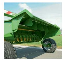
Ganz nach Ihren Wünschen: Die optionalen Leitbleche für die Breitablage sind über Lochsegmente einstellbar. Sie können wählen: Auf nassem und nachgiebigem Untergrund das schmale Schwad, zum schnelleren Abtrocknen die breite Ablage.
