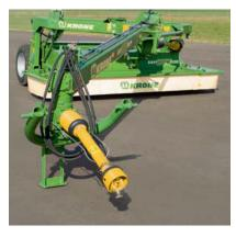
Praktisch: Mit schwenkbarer Abstellstütze steht der Mäher auf sicherem Fuß. Halter sorgen für eine ordentliche Unterbringung der Gelenkwelle und Hydraulikleitungen. Der seitlich bewegliche Zweipunktbock erleichtert das Ankoppeln des Mähers.
