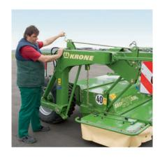
Schnitthöheneinstellung – komfortabel und schnell: Über Gewindespindeln lassen sich die Arbeitstiefen der einzelnen Mähholme stufenlos einstellen.
