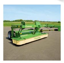
DuoGrip: Mähen mit verteilten Lasten! Das seitliche Lenkerparallelogramm gibt der im Schwerpunkt aufgehängten Mäheinheit zusätzlich Führung. DuoGrip fängt seitliche Kräfte ab, entlastet die Schwerpunktaufhängung und macht den Mäher noch robuster.
