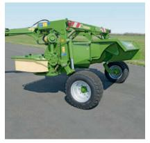
Schnell gemacht: Für den Straßentransport wird der Mäher hydraulisch ausgehoben und zur Mitte geschwenkt. Das gibt viel Bodenfreiheit, ideal beim Überfahren tiefer Fahrspuren und bereits abgelegter Schwaden.
