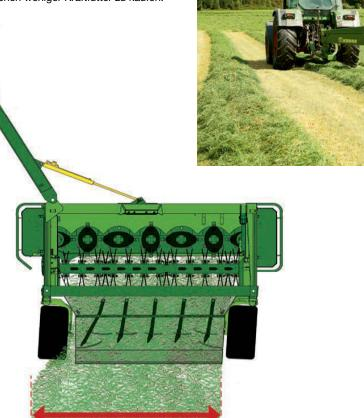
Mit voller Breite: Der Aufbereiter mit seinen V-förmigen Stahlzinken und dem Riffelblech erstreckt sich über den vollen Mähbereich, von der linken zur rechten Mähtrommel. Das bewirkt den gleichmäßigen Gutstrom über die gesamte Arbeitsbreite und ergibt den optimalen Aufschluss des Futters. Zusätzliche Leitbleche ermöglichen die Breitablage und eine damit noch schnellere Aufbereitung
