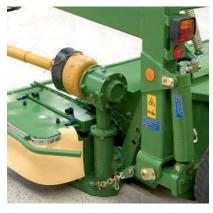
Voller Kraftschluss: Der Antrieb des Rollenaufbereiters erfolgt direkt und schlupffrei über Getriebe. Der untere Walzenantrieb ist im Antrieb des Mähholmes hinter der linken Trommel integriert.
