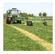
EasyCut 2801 CV, 3200, 3200 CV, 3201 CV, 3200 CRi und 3600 CV mit seitlicher Deichselanlenkung: Ideal zum Rundummähen ohne Unterbrechung, ohne Ausheben und Rückwärtsfahren, auch in Kurven und Ecken.
