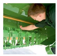
EasyCut 2801 CV, 3200 CV, 3201 CV, 3210 CV, 3600 CV und 4013 CV mit breitem V-Stahlzinkenaufbereiter: Die frei beweglichen V-Stahlzinken sorgen für eine gleichmäßige Aufbereitung über die gesamte Arbeitsbreite.
