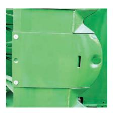
Gleiten – leicht gemacht: Die sehr breiten, angeschraubten Gleitkufen aus gehärtetem Stahl schützen den Mähholm und schonen die Grasnarbe. Mit Hochschnittkufen für Stoppellängen von über 80 mm mähen Sie je nach Montage 30 bzw. 50 mm höher.
