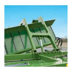
Ideal: Der Aushub des Querförderbandes erfolgt über einen einfachwirkenden Hydraulikzylinder. Ein Umschaltventil schaltet während des Schwenkvorganges nach oben den Antrieb des Bandes ab, beim Ablassen zu.
