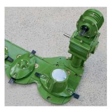
Elegant gelöst: Der Antrieb des Mähholmes und Aufbereiters erfolgt über ein gemeinsames Getriebe direkt hinter der inneren Räumtrommel. Damit ist ein verstopfungsfreies Arbeiten am Vorgewende oder in keilförmig auslaufenden Beständen gewährleistet.
