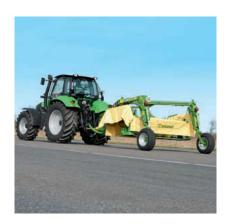
Kompakt: Zum Transport wird das EasyCut 3200 mittig hinter den Traktor geschwenkt. Mit 3,00 m Transportbreite, viel Bodenfreiheit und einer zugelassenen Höchstgeschwindigkeit von 40 km/h sind Sie schnell und sicher am Einsatzort.
