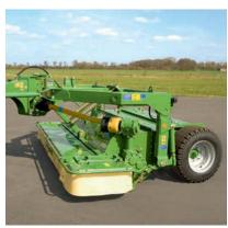
Passt sich an: Die im Doppelrahmen pendelnd aufgehängte Mäheinheit ist nach oben und unten hin voll beweglich, ideal bei Bodenwellen und Hindernissen. Je strammer die Zugfedern eingestellt sind, umso leichter reagiert die Mäheinheit.
