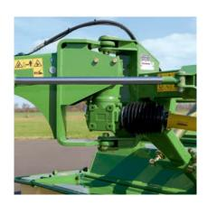
Kraftschlüssig – ohne Riemen: Der Antrieb des Mähholmes und des Aufbereiters erfolgt über Getriebe und Antriebswellen. Zwei Schwenkgetriebe optimieren den Lauf der Antriebswellen. Eine Überlastsicherung im Antriebsstrang zum Mäher gibt Sicherheit.
