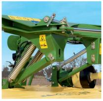
Passend: Der V-förmige Rahmen des EasyCut 3200 mit Seitendeichsel ist robust und kompakt. Die Rahmenhöhe ermöglicht einen großen Pendelweg des im Schwerpunkt aufgehängten und von seitlichen Lenkern geführten Mähholmes. Damit hinterlässt das EasyCut 3200 auch auf unebenem Untergrund eine saubere, verlustfreie Mahd. Der Antrieb des Mähholmes erfolgt kraftschlüssig über Gelenkwellen und einem starken Winkelgetriebe hinter der inneren Mähtrommel.
