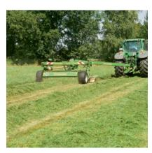
EasyCut 3210 CV, 3210 CRi und 4013 CV mit hydraulisch schwenkbarer, mittig angeordneter Deichsel: Mit diesen Mähern können Sie links oder rechts vom Traktor mähen. Ideal für die Arbeit auf größeren Schlägen.
