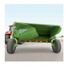
Zum perfekten Doppelschwad: Die langen, schwenkbaren Schwadklappen bündeln das Mähgut und legen das aufbereitete Futter sauber zur Seite hin ab. Die so entstehenden Doppelschwade liegen locker und lassen sich bestens aufnehmen.
