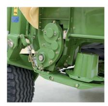
Serienmäßig mit zweifacher Power: Auch die obere Walze wird aktiv angetrieben. Der zusätzliche Antrieb erfolgt synchron über ein Getriebe an der rechten Außenseite des Mähholmes von der unteren Walze aus.
