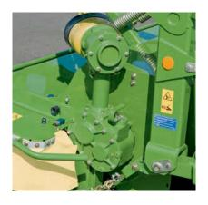
Beides in einem: Der Antrieb von Mähholm und Aufbereiter erfolgt über ein gemeinsames Getriebe. Das integrierte Schaltgetriebe für den Aufbereiter CV verfügt über zwei Drehzahlen: 600 und 900 U/min.
