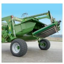
Nichts geht verloren: In Kombination mit einem Querförderband sind alle gezogenen Scheibenmäher EasyCut CV mit einer Stahlwanne unterhalb des V-Stahlzinkenaufbereiters ausgerüstet. Damit ist die verlustfreie Beschickung des Bandes gewährleistet.
