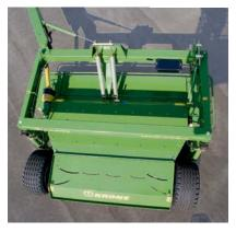
Ausbalanciert mähen: Mit im Schwerpunkt aufgehängtem und gezogenem Mähholm arbeitet es sich besser. DuoGrip steht für Leichtzügigkeit, sauberes Futter und Erhalt der wertvollen Grasnarbe bei gleichem Auflagedruck über die komplette Arbeitsbreite.
