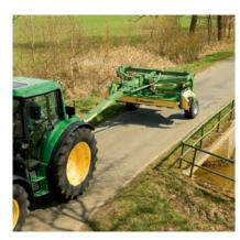
Mit 40 km/h von Ort zu Ort: Die zur Mitte geschwenkten EasyCut 3210 CV und CRi sind für den öffentlichen Verkehr zugelassen und benötigen mit einer Transportbreite von bis zu 3.000 mm keine Sondergenehmigung.
