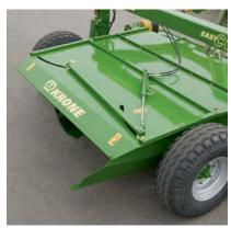
Ganz nach Ihren Wünschen: Die beiden Schwadklappen sind über ein Gestänge miteinander verbunden und lassen sich zentral über einen doppelt wirkenden Hydraulikzylinder nach links oder rechts schwenken.
