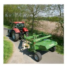
40 km/h – schnell unterwegs: Mit Transportbreiten von bis zu 3.000 mm benötigen die EasyCut 2800 CV/CRi, 3200 CV/CRi und 3201 CV keine Sondergenehmigung für den öffentlichen Verkehr.
