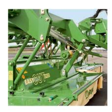
Beste Bodenanpassung: kein durchgehender Mähholm, sondern zwei zueinander versetzt angeordnete Mähholme. Sie arbeiten voneinander unabhängig und folgen jeder Bodenkontur. Mit einem EasyCut 6210 CV gewinnen Sie Qualitätsfutter.
