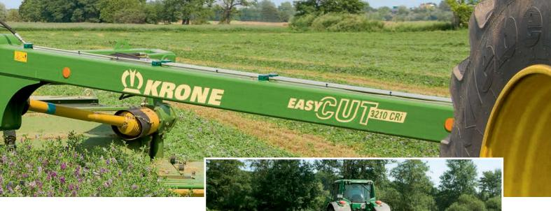
Die gezogenen Scheibenmäher EasyCut 3210 CV oder CRi und 4013 CV arbeiten weltweit und haben sich im Solo-Einsatz oder in Kombination mit Frontmähern bestens bewährt. Mit der mittig angeordneten Schwenkdeichsel können Sie im Anschluss in beide Richtungen mähen.
