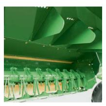
Für Super-Futter: Die Hochleistungs-Aufbereiter mit pendelnden V-Stahlzinken und Schaltgetriebe bearbeiten das Futter über die gesamte Arbeitsbreite mit 600 oder 900 U/min. Optionale Leitbleche ermöglichen eine Breitverteilung und beschleunigen die Abtrocknung.
