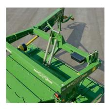
Weniger Auflagedruck – mehr Auflagedruck: Die Zugfedern ermöglichen die schnelle und optimale Anpassung an alle Verhältnisse. Ihr weiter Einstellbereich und die leichte Handhabung überzeugen.
