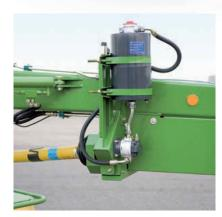
Mit Bordhydraulik: Der Antrieb des Querförderbandes wird von einem separaten Öltank aus versorgt. Damit sind Sie vom Ölkreislauf des Traktors unabhängig. Die Traktor-Hydraulik wird entlastet und weniger in Anspruch genommen.
