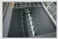
Schutzgitter mit integriertem Sicherheitsschalter, weit aufzuklappen für optimale Zugänglichkeit zum Warten und Reinigen
