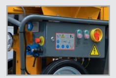
Zentraler Schaltschrank dient gleichzeitig als Stromverteiler für Anbaugeräte wie Tellermischer oder Kompressoren
