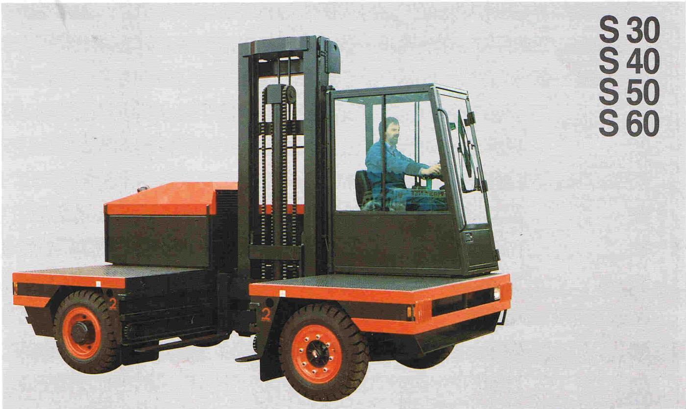
Die Linde-Seitenstapler der Baureihe S30 bis S60 eignen sich hervorragend zum Transport langer Lasten mit Gewichten bis zu 6000 kg. Kompakte Abmessungen, ein kleiner Wendekreis und hydrostatische Lenkung gewährleisten eine gute Manövrierfähigkeit. Großvolumige Reifen, eine hohe Bodenfreiheit sowie hydraulische Plattformneigung mit Differentialausgleich erlauben einen hohen Fahrkomfort auch bei schlechten Bodenverhältnissen.
