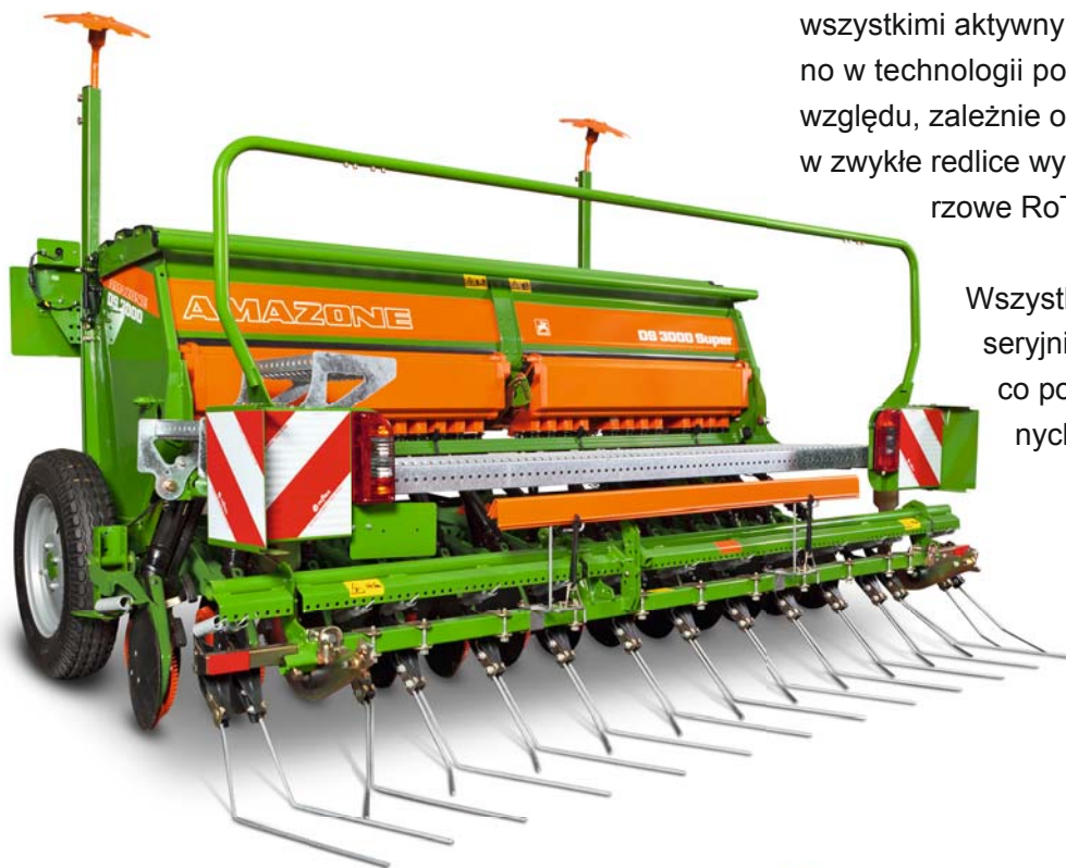
D9 3000 Super o szerokości roboczej 3 m i redlicami talerzowymi RoTeC-Control (tutaj z bocznymi tablicami ostrzegawczymi specjalnie na rynek francuski)
