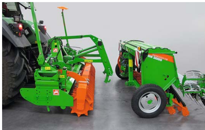
Hydrauliczny system sprzęgowy AMAZONE „Huckepack”
