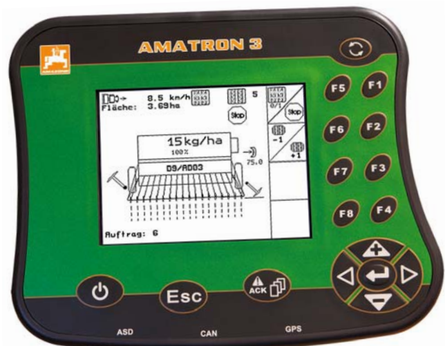
AMATRON 3: terminal obsługowy dla siewników, rozsiewaczy nawozów i opryskiwaczy
