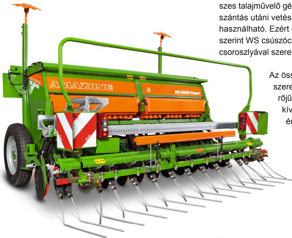
D9 3000 Super 3 m munkaszélességgel és RoTeC-Control-tárcsás csoroszlyákkal. (Az ábrán speciálisan a francia követelményeknek megfelelő oldalsó figyelmeztető táblákkal)
