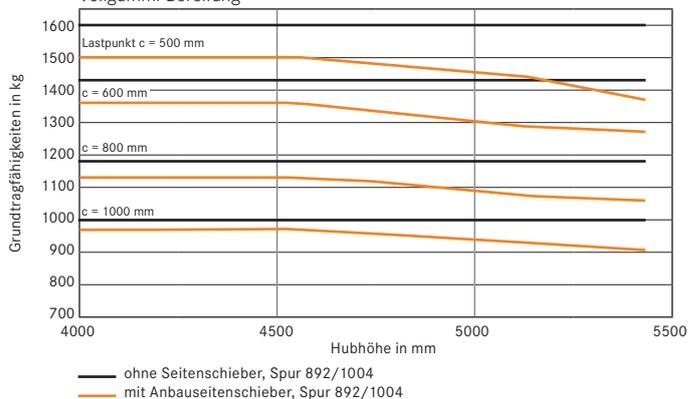
Grundtragfähigkeiten RX 50-15 Dreifach-Hubgerüst SE-Bereifung
