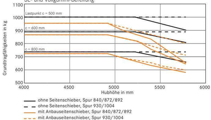
Grundtragfähigkeiten RX 50-13 Tele-/Niho-Hubgerüst Vollgummi-Bereifung
