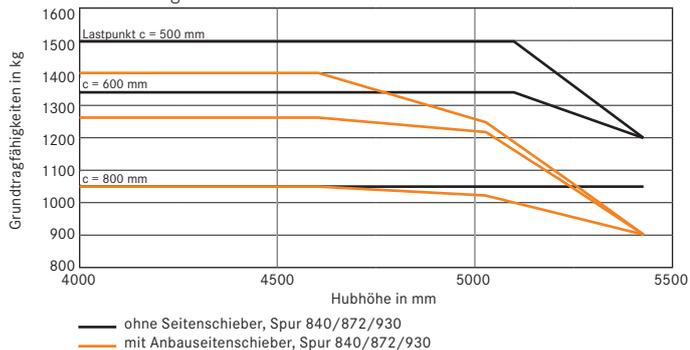
Grundtragfähigkeiten RX 50-16 Tele-/Niho-Hubgerüst SE-Bereifung
