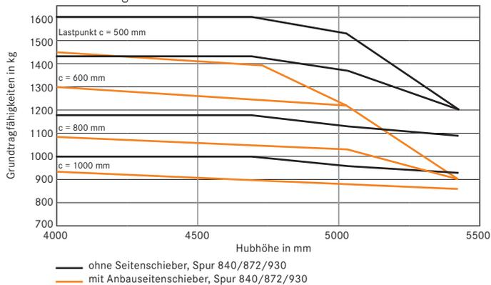
Grundtragfähigkeiten RX 50-15 Tele-/Niho-Hubgerüst Vollgummi-Bereifung
