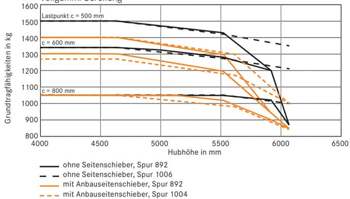
Grundtragfähigkeiten RX 50-16 Dreifach-Hubgerüst Vollgummi-Bereifung
