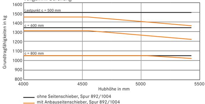
Grundtragfähigkeiten RX 50-16 Tele-/Niho-Hubgerüst Vollgummi-Bereifung
