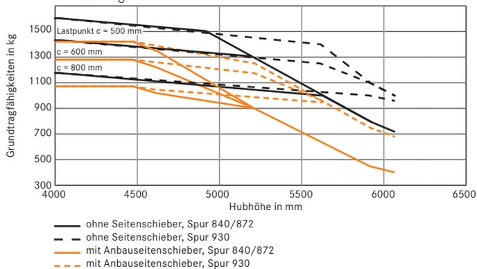
Grundtragfähigkeiten RX 50-15 Dreifach-Hubgerüst Vollgummi-Bereifung
