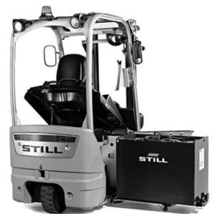
4) On-Board-Batteriebrücke für Wechsel mit Kran
