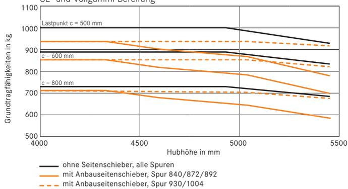
Grundtragfähigkeiten RX 50-13 Tele-/Niho-Hubgerüst SE-Bereifung
