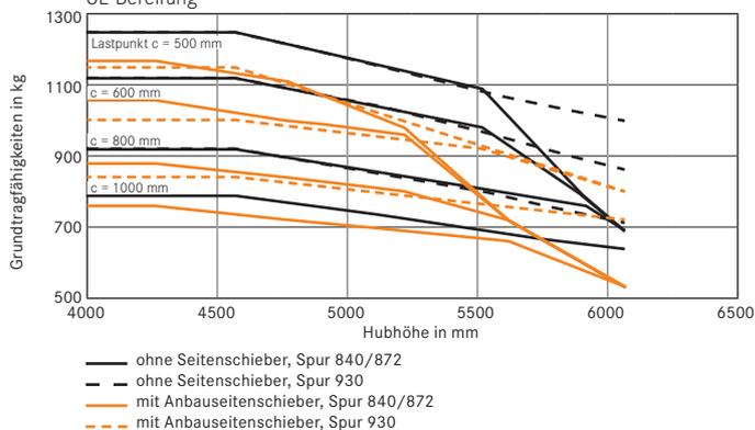
Grundtragfähigkeiten RX 50-13 Dreifach-Hubgerüst Vollgummi-Bereifung
