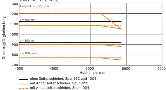
Grundtragfähigkeiten RX 50-10 C Dreifach-Hubgerüst SE- und Vollgummi-Bereifung
