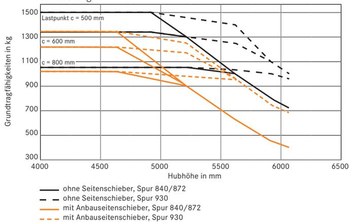
Grundtragfähigkeiten RX 50-16 Dreifach-Hubgerüst SE-Bereifung
