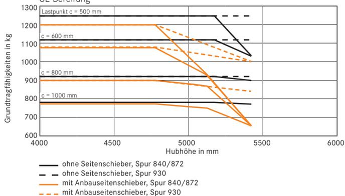
Grundtragfähigkeiten RX 50-10 Dreifach-Hubgerüst SE- und Vollgummi-Bereifung
