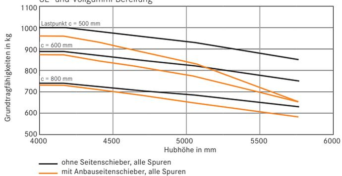
Grundtragfähigkeiten RX 50-13 Dreifach-Hubgerüst SE-Bereifung
