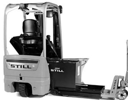
3) Wechsel mit Standard-Handgabelhubwagen, Niederhubwagen und Batteriewechselgestell
