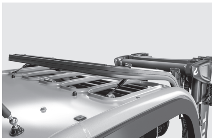
Vitre de toit ouvrante pour une température agréable au poste de travail
