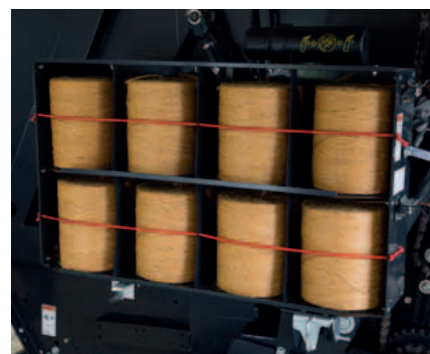
Alloggiamento bobine di spago.
