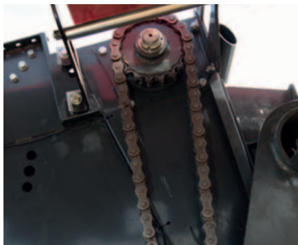
La catena di trasmissione principale è da 1"1/4 a garanzia di lunga durata e manutenzione ridotta.
