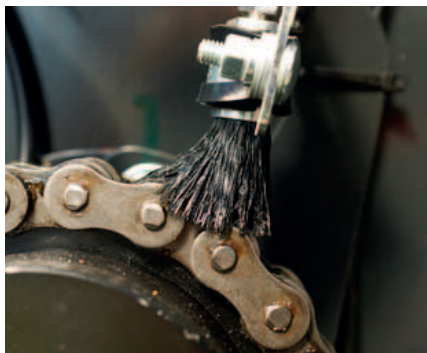
La lubrificazione automatica delle catene è standard ed è attivata in modo continuo ad un livello predeterminato per ogni catena.
