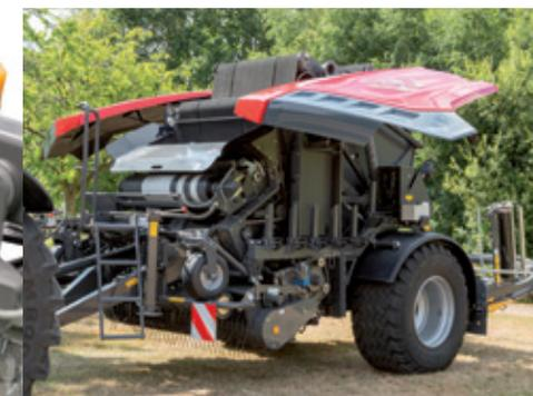
Dodici portabobine sono posizionate alla giusta altezza su entrambi i lati della pressa, mentre due bobine supplementari installati sull'unità di fasciatura permettono di aumentare i ritmi di lavoro sul campo.
