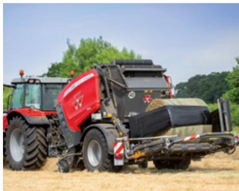
Non appena la palla viene trasferita al centro del piano di fasciatura, l'anello a comando idraulico inizia a ruotare ancora prima che il portellone venga chiuso completamente. In questo modo la fasciatura viene completata prima ancora che la palla successiva venga formata. Progettata per sopportare i carichi più impegnativi, la robusta struttura e la relativa trasmissione, molto silenziosa, consentono una fasciatura senza intoppi, palla dopo palla.
