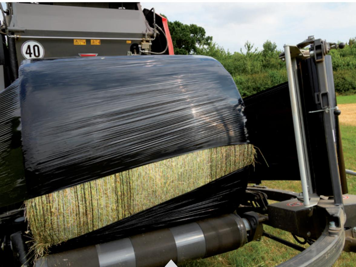
Il piano di fasciatura a comando idraulico è costituito da due rulli e tre nastri trasportatori montati su un telaio saldato ad alta resistenza. Un sensore posizionato al di sotto del nastro centrale dà la via libera alle operazioni di fasciatura solo dopo aver rilevato che la palla è posizionata correttamente sul piano di lavoro. Durante la fasciatura, la palla è tenuta in posizione da quattro rulli di supporto laterali.
