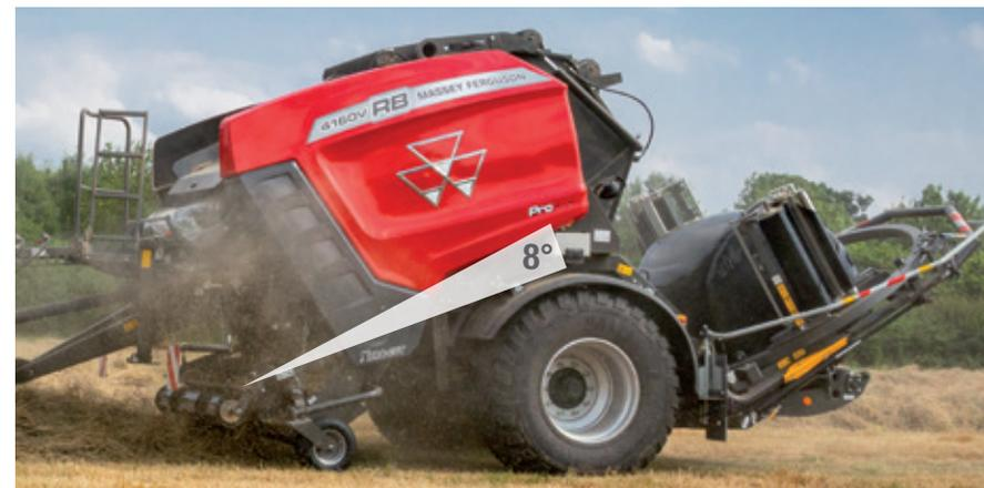
La nuova unità Protec presenta un angolo di taglio ribassato che consente di diminuire l'altezza complessiva della pressa, migliorando così la stabilità, la sicurezza e le prestazioni durante i lavori su pendii. Anche la pressione nella zona di alimentazione viene ridotta: in questo modo il raccolto scorre meglio e il rischio di blocchi è minimo.
