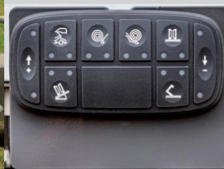
Il pannello di comando esterno, sul retro della pressa, permette di controllare l'uscita, l'anello e il piano di fasciatura nonché i fermi dei rulli per la sostituzione, la manutenzione e la pulizia delle bobine di fasciatura.
