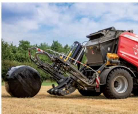
Per scaricare le balle delicatamente, il pianale dell'unità di fasciatura è ribassato per essere più vicino al terreno e diminuire la velocità di rotazione della palla che in questo modo non si danneggia durante la posa e preserva la sua forma ideale. Un sistema di ribaltamento delle balle (optional) evita che queste possano rotolare e permette di caricarle più agevolmente sul rimorchio. L'operatore può scegliere tra la modalità di scarico manuale o automatica.
