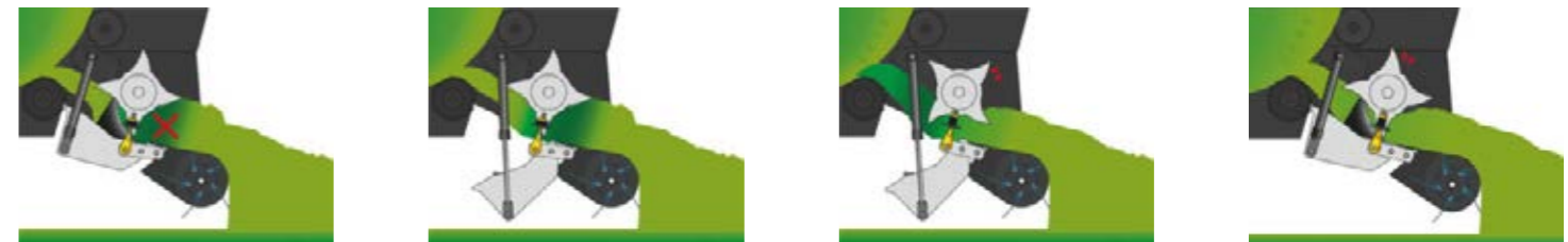
W razie ich wystąpienia tylna część podłogi zespołu tnącego jest obniżana o 500 mm.
