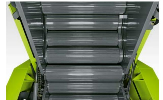
Risultato: le balle possono ruotare liberamente, e la pressatura non viene interrotta. E voi potete produrre balle con un diametro di 1,25 - 1,35 metri, in base alle vostre esigenze.
