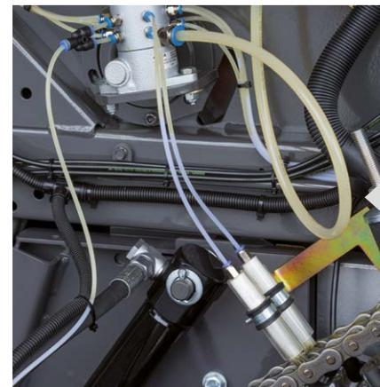
La lubrification automatique des chaînes, avec réglage individuel pour chaque chaîne, garantit une alimentation suffisante en huile, réduit le temps d'entretien et prolonge la durée de vie de la chaîne. Et pour une durabilité renforcée, la presse à balles rondes est dotée des meilleures chaînes du marché.
