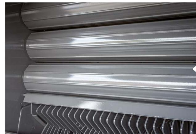
Les roulements à rouleaux dans la chambre de pressage se composent de carters autonettoyants permettant d'évacuer les déchets et l'humidité de la zone du roulement et ainsi prolonger sa durée de vie.
