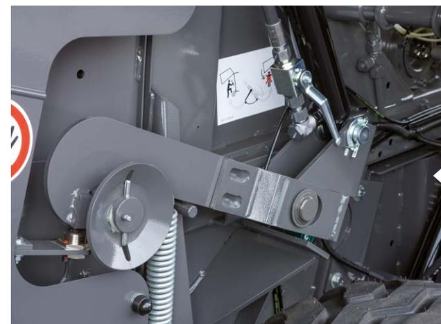
Simple, rapide et efficace, le dispositif de verrouillage mécanique de la porte permet d'obtenir un diamètre uniforme et une haute densité de balle et de réduire la consommation de puissance.
