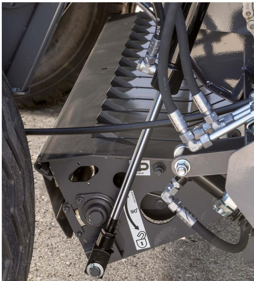
La première fonction du système Hydroflexcontrol permet de déplacer la partie avant du fond de la chambre d'alimentation et d'éviter automatiquement jusqu'à 80 % des bourrages potentiels, pour continuer à travailler sans temps d'immobilisation inutiles.
