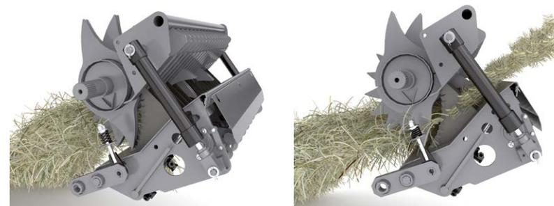
Le système de protection breveté évite que les pointes de charge provoquent des bourrages en descendant délicatement le fond suspendu à des blocs en caoutchouc ou des ressorts en acier, selon le modèle.
