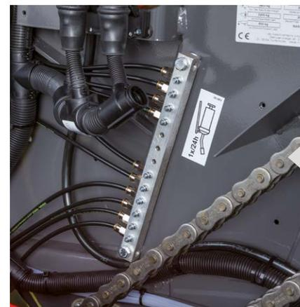
Une lubrification suffisante et régulière des roulements à rouleaux est très importante, notamment dans des conditions difficiles comme le pressage d'ensilage. Les banques de graisseurs centralisés pour la lubrification des roulements à rouleaux sont stratégiquement situées pour en faciliter l'accès et réduire le temps d'entretien.
