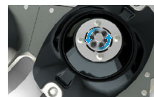
L'élément de surcharge se cisaille - le disque de coupe tourne librement - protection de l'entraînement
