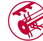
Der Federzinkenrotor und der mehrstufig verstellbare Aufbereiterkamm erzeugen mit ihren vielen ineinandergreifenden Arbeitswerkzeugen eine wellige, luftdurchlässige Futterstruktur und öffnen die oberste Blattschicht zur Erleichterung des Wasseraustritts.
