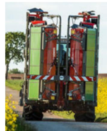
Eine rechnergestützte automatische Klappfunktion mit hydraulischer Transportsicherung erlaubt ein komfortables Umstellen auf Transportstellung und sichert zudem den Antriebsstrang der Maschine gegen Beschädigungen.
