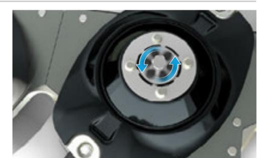
Überlast-Element schert ab – Mähscheibe dreht frei – Schutz des Antriebs
