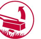
Die patentierte Anfahrtsicherung SafetySwing sorgt für optimale Sicherheit auf jedem Feld und schützt Ihre Maschine zuverlässig vor Schäden durch angefahrene Gegenstände. Das Mähwerk klappt beim Auftreffen auf ein Hindernis nach hinten oben weg und anschließend selbstständig durch das Eigengewicht wieder zurück. Jede Mäheinheit ist dabei separat abgesichert und kann einzeln ausweichen.
