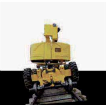
CAN OPERATE ON 200MM CANTS WITH AUTOMATIC LEVELLING OF THE TURRET MAINTAINING A LEVEL WORKING POSITION. HIGH SPEED TRAVEL ON RAILS OF 8KM/H (5MPH). SIDE OUTREACH AVAILABLE WHILST BEING DRIVEN ON RAIL. AUTO-DIRECTIONAL CHANGE RED-WHITE RAIL LIGHTING.
