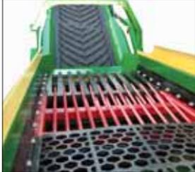
Chapa perforada, piso de varillas (*fingers*) y piso de barras de acero tipo Bofor.
