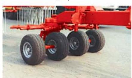
на мокрых лугах и крутых склонах. Со сдвоенными колесами машина абсолютно устойчива.
