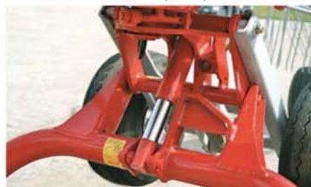
При поднятии секции на переездах или поворотных полосах сдвоенные колеса тандемного типа также поднимаются.
