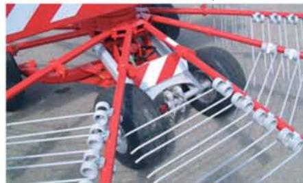
условиях работы. Возможна поставка сдвоенных колес тандемного типа и для передней секции. Благодаря этому область применения практически безгранична.
