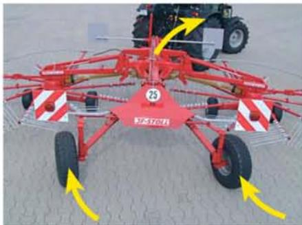
Безопасные переезды, соответствуют ПДД. Подвижность шины амортизирована. Это облегчает навешивание машины.
