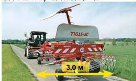
Поднятие валкообразующего фартука автоматическое, не выходя из трактора. Транспортная ширина со снятыми граблями 2,20м.
